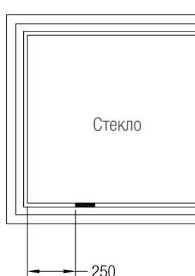
При очень широких заполнениях допускается размещение подкладок на расстоянии до 250 мм от угла заполнения. Несущие подкладки должны устанавливаться в местах крепления коробки к несущей конструкции здания.
