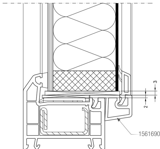
Заполнения толщиной 30-55 мм могут быть установлены с использованием расширителя фальца остекления арт. 1561690.
